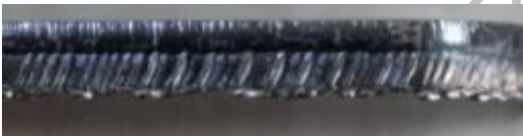
Joonis 3 Liige kiire lõikekiiruse puhul jääv servakvaliteet
