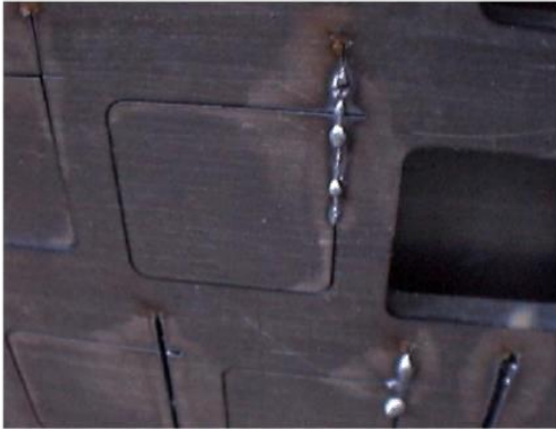
Joonis 5 Plaati ei saa läbi lõigata, kui võimsus on liiga väike
